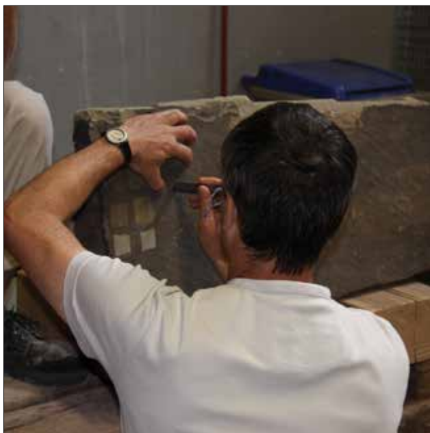
Sondage de la pierre avec un « outil » en plomb
