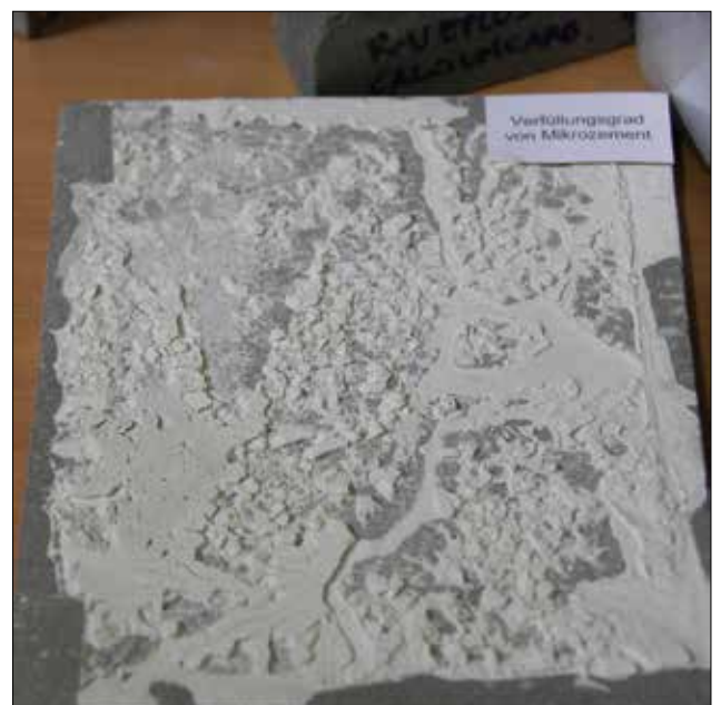
Essai avec le microciment : il se propage de manière satisfaisante, permet les échanges hydriques et conserve une certaine souplesse tout en assurant le liaisonnement des deux éléments
