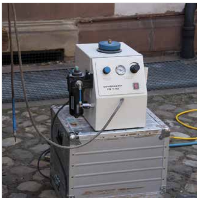
Micro-gommeuse utilisée avec de la poudre de corindon blanc à une pression de 0,5 à 1 bars
